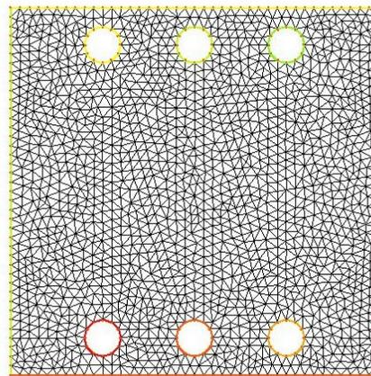
FIGURE 2 – Triangulation du domaine avec six trous.
