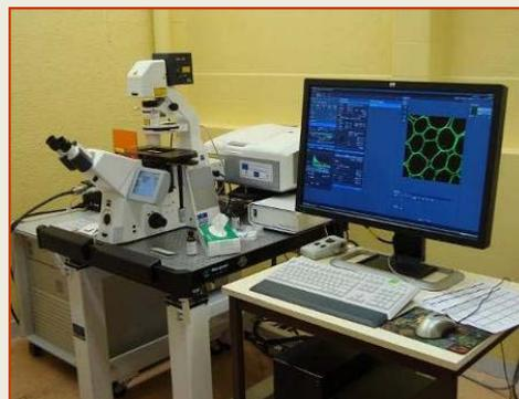
**Microscope Confocal à Balayage Laser**
